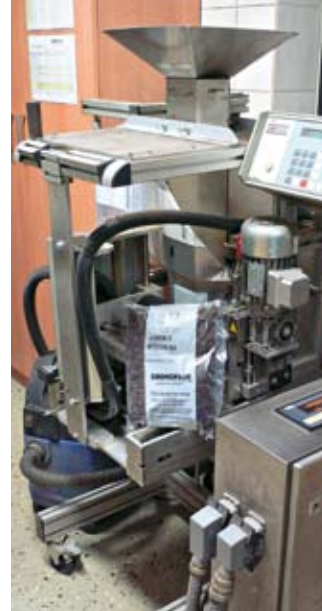
Das Rückstellmustererfassungsgerät entnimmt automatisch alle 5 Sekunden eine Substratprobe
