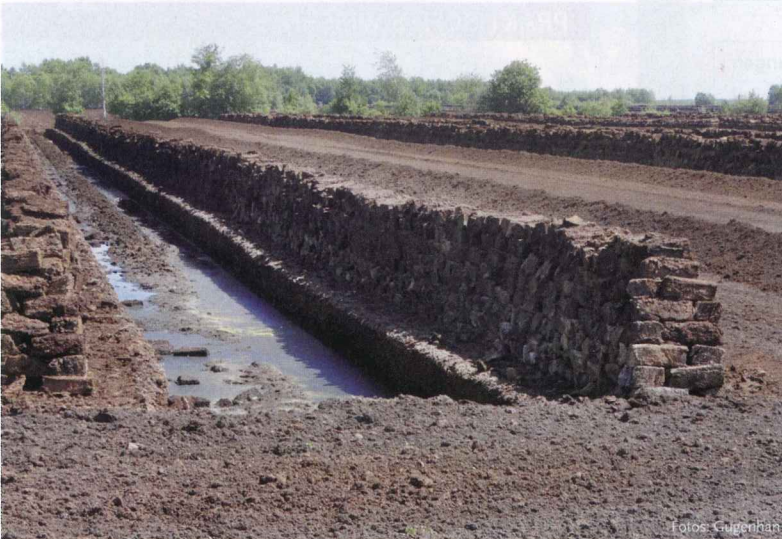
Nach einem genau festgelegten System werden die Torfvorräte abgebaut und zwar immer in einzelnen Abschnitten.
