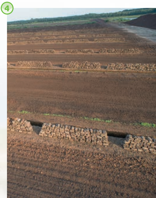
Die Torfgewinnung erfolgt bereits seit 1981 nach dem Niedersächsischen Moorschutzprogramm. Hier im Sodenstechverfahren
